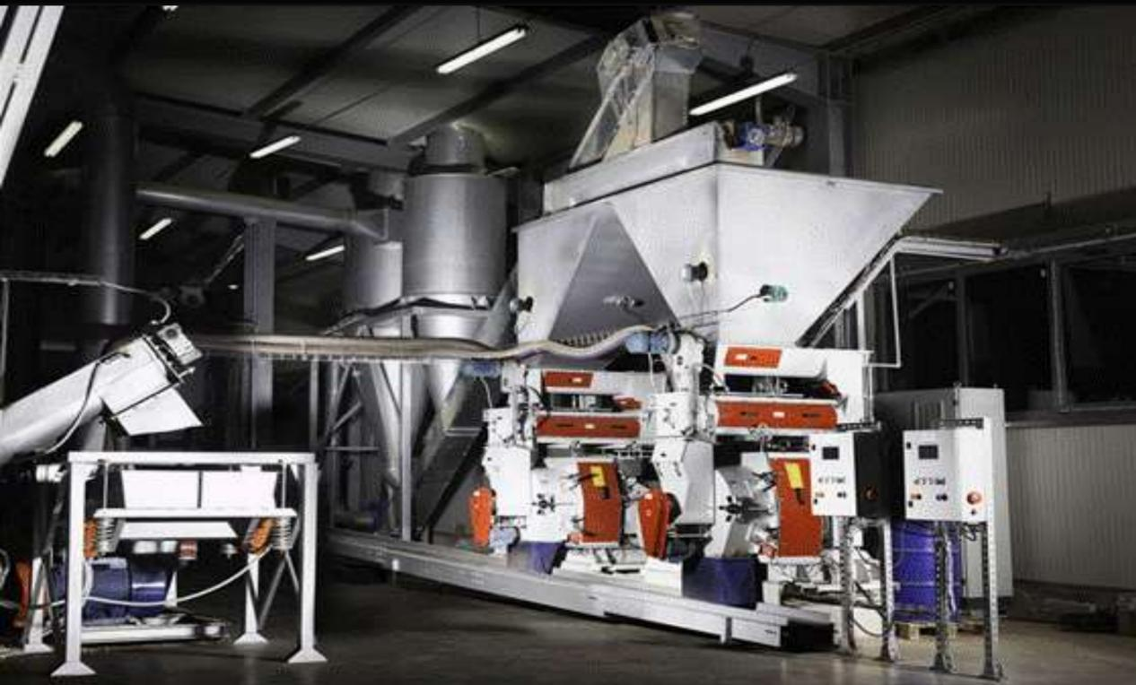
**EQUIPAMENTO 27 LAYOUT EXPANSOR** . Sistema de expansão e de ligação dos pellets em fase final para o sistema de embalagem industrial.
