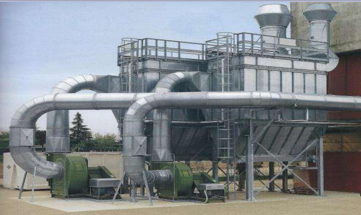
**EQUIPAMENTO 30 LAYOUT EXAUSTOR DO RESFRIADO.** Sistema de aspiração da matéria-prima que passou pelo processo de refinação e de resfriamento composto com de tubos de conexão e um ciclone e uma válvula do tipo estrela acoplada ao ventilador elétrico.
