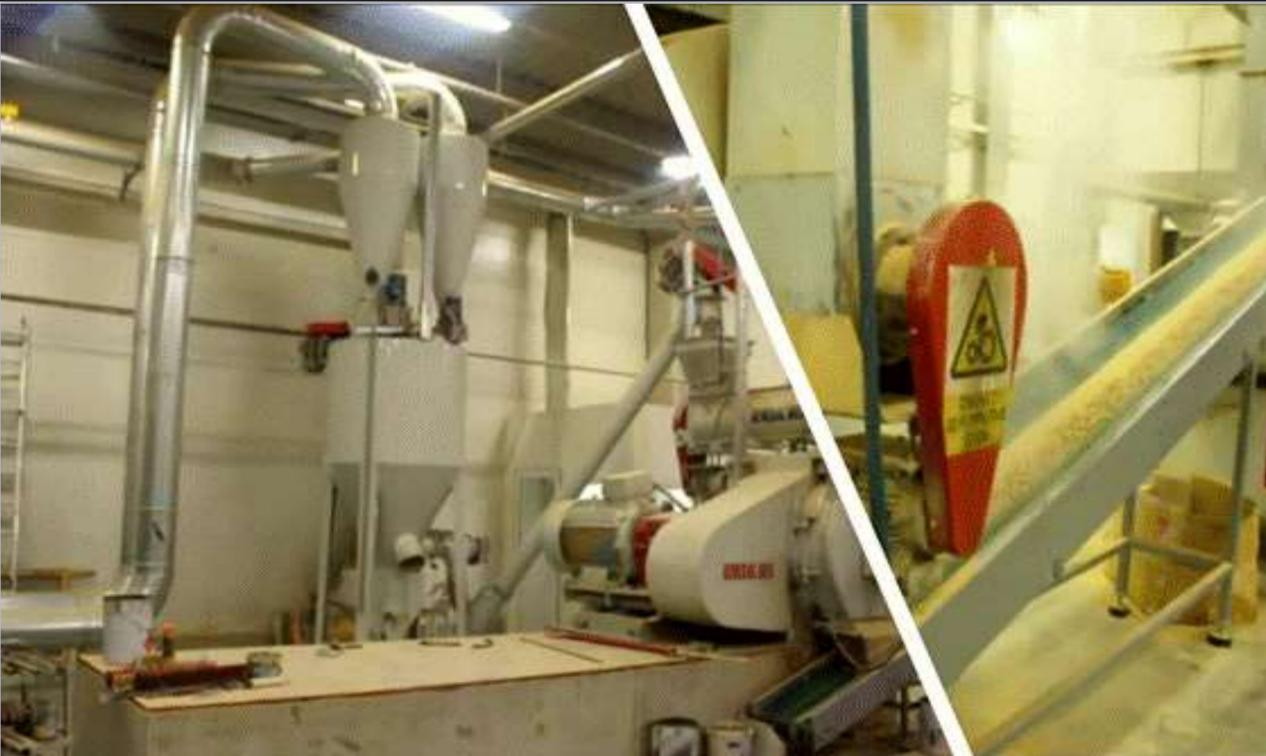
**EQUIPAMENTO 23 LAYOUT DE TRANSPORTE DE PELLETS PRODUZIDOS.** Sistema de transporte dos pellets produzidos (evacuação da peletizadora) e quentes para o sistema de refrigeração industrial.
