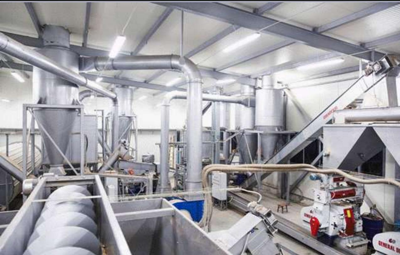
**EQUIPAMENTO 13 LAYOUT SISTEMA DE TRANSPORTE DE MATÉRIA-PRIMA.** Sistema de Transporte com sistema de parafuso para o transporte da matéria-prima para a área de refinação. Construídas seguindo modernas padronizações internacionais para este tipo de equipamento construído para transporte de produto em chapa calandrada.
