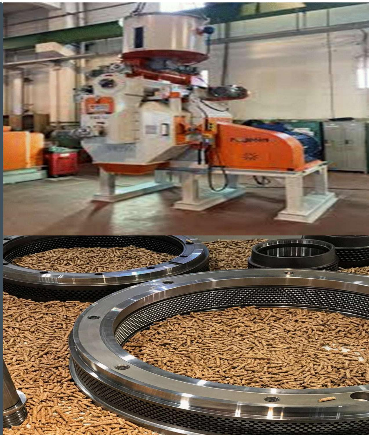
**SISTEMA INDUSTRIAL 4.0 DE PELETIZAÇÃO.** Os equipamentos de peletização permitem executar o processo após a secagem, moagem e condicionamento da matéria-prima . Permite a produção de um produto homogêneo em relação à forma, tamanho e consistência. O produto final, caracterizado por maior densidade e valor de aquecimento por unidade de volume, é adequado para embalagem, armazenamento, transporte e usabilidade.
