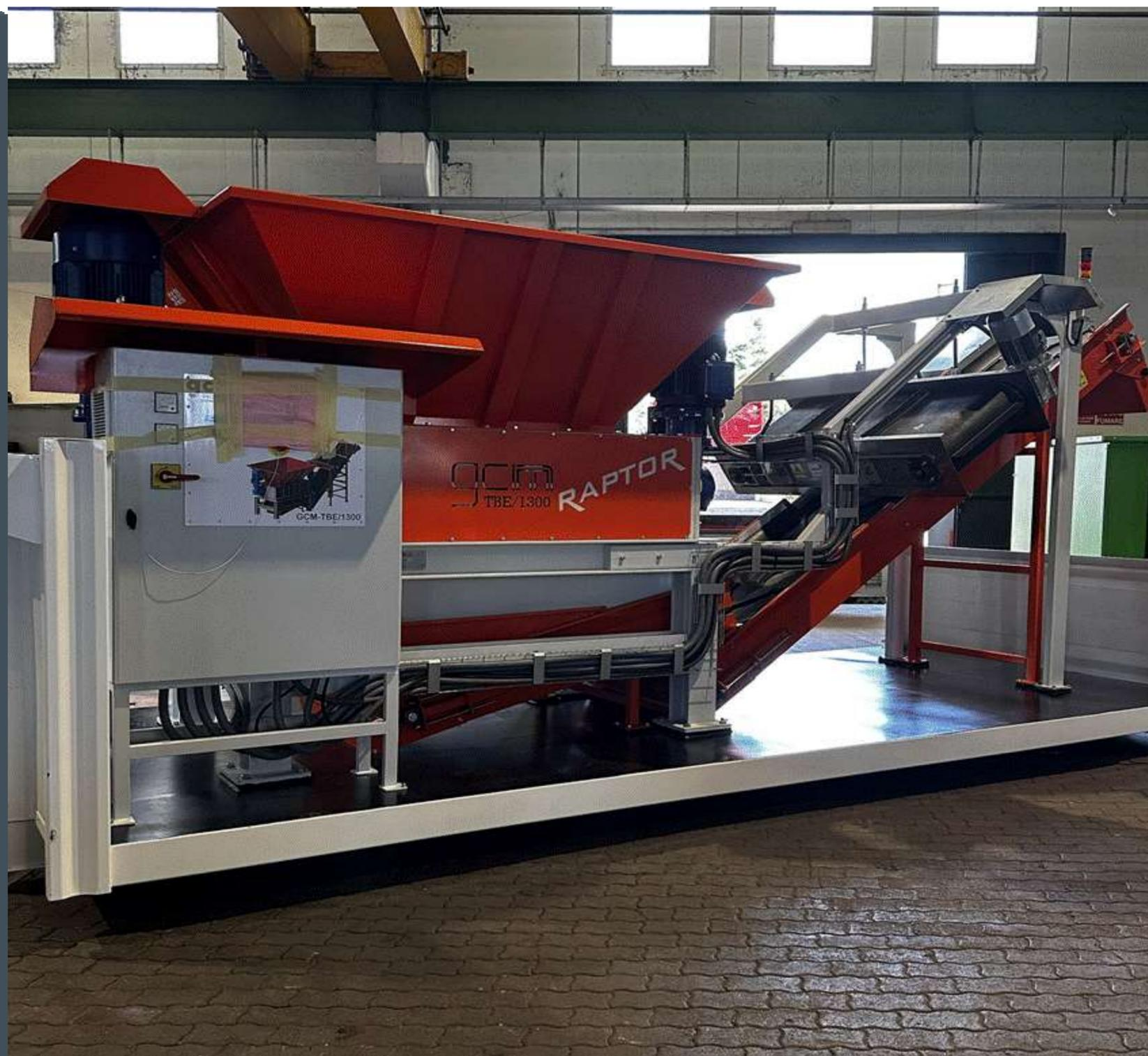
**TREMONHA DE ALIMENTAÇÃO.** A tremonha de alimentação é uma estruturas empregadas para saída (alimentação) da matéria-prima (cavaco de madeira) a granel. Equipamentos desenvolvidos em conformidade com NR12 e demais normas de segurança vigente com atenção a proteções mecânicas, portas de inspeção, identificação de áreas de risco, posicionamento de botoeiras e chaves de emergência, escadas e passadiços com piso e guarda corpo apropriados ao local de trabalho.
