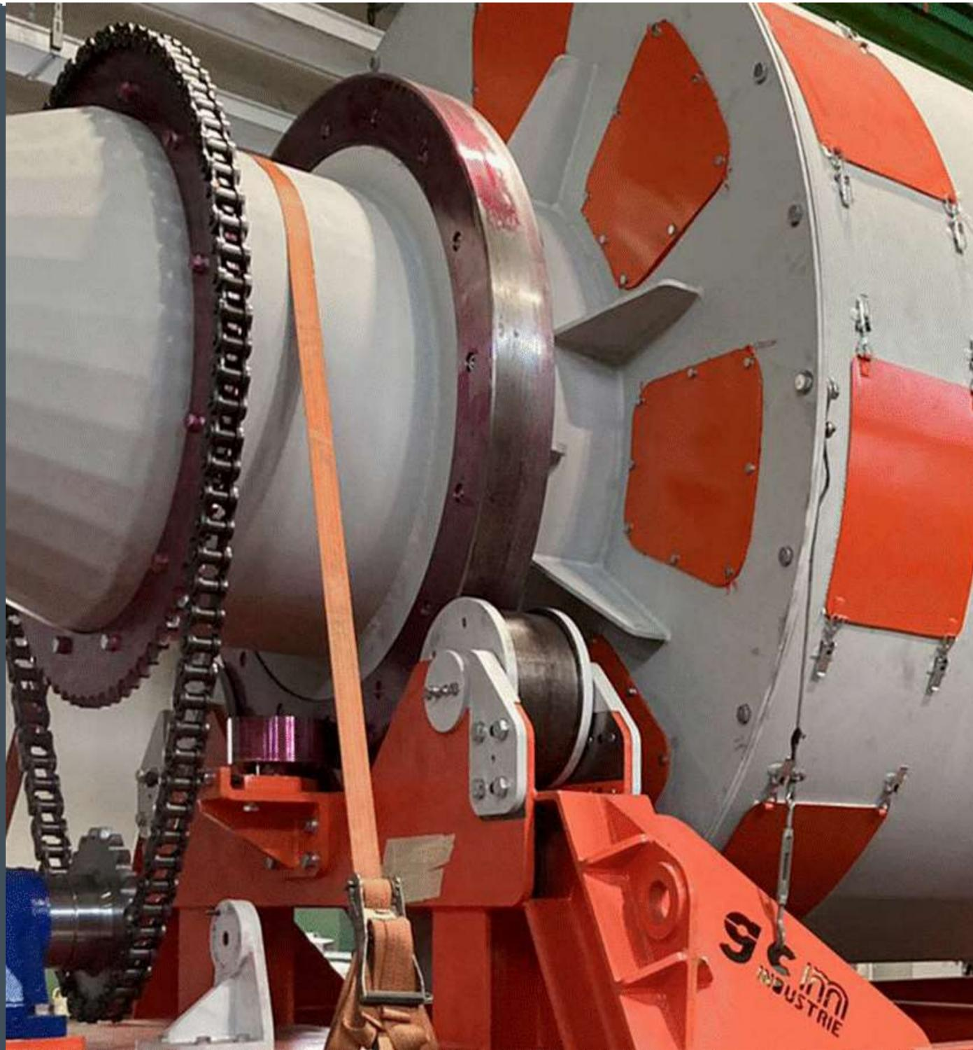
**SISTEMA DE SECAGEM DA MATÉRIA-PRIMA.** Como a matéria-prima costuma apresentar um conteúdo de umidade superior a 50%, torna-se necessário antes da sua utilização, reduzir o valor de umidade. O secador industrial diminui a umidade por meio de um fluxo contínuo de ar quente com um consumo médio de energia de 1MW/ton de material seco. A secagem é a etapa que consome mais energia na produção de pellets.
